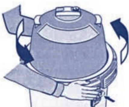
Figure 4 Appuyer sur le loquet de sécurité pour dévisser la bague de fermeture.
