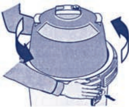
Abbildung 4: Lasche eindrücken zum Öffnen des Gewindinges.
