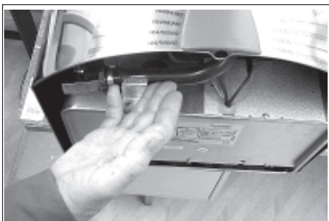
Sicht von unten: Wasserschlauch so vom Bügel abnehmen, dass er senkrecht hängt.
