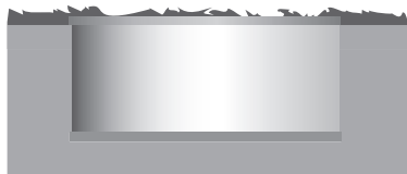
Rundformbecken als Tiefbecken, mit Magerbetonhinterfüllung.
